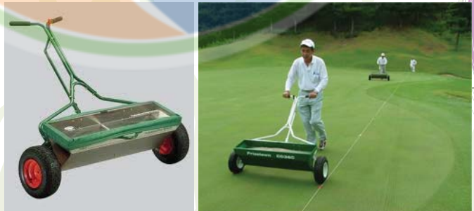
Gambar 8.13: Drop type spreader yang digunakan untuk membaja kawasan turf yang kecil.
