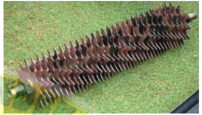
Gambar 8.28: Mata yang digunakan bagi kerja pengudaraan tanah melalui kaedah slicing .
