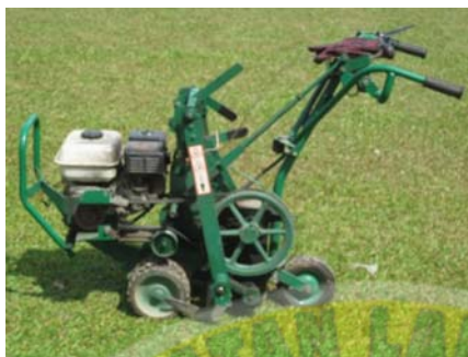
Gambar 3.24: Mesin sod cutter yang digunakan untuk memotong kepingan turf.
