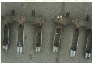
Gambar 8.25: Mata yang digunakan bagi kerja hollow tine .
