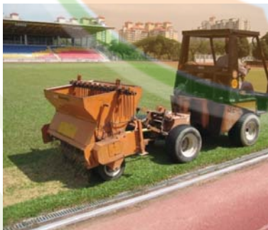
Gambar 3.23: Peralatan spreader , digunakan untuk kerja-kerja pembajaan dan top dress .
