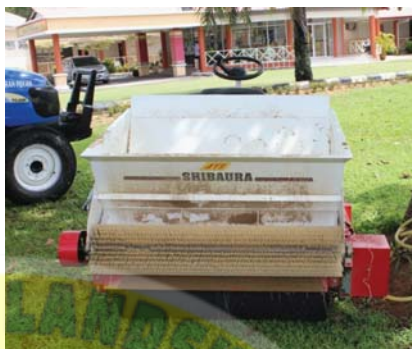
Gambar 3.32: Jentera yang digunakan bagi kerja top dress terutama di kawasan turf yang berskala besar.
