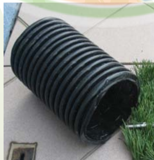
Gambar 3.4: Corrugated and perforated subsoil pipe (double wall HDPE) yang biasa digunakan dalam sistem saliran.
