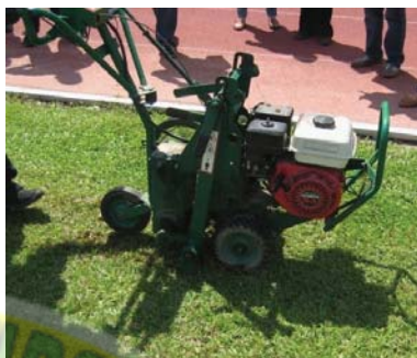
Gambar 3.24: Mesin sod cutter yang digunakan untuk memotong kepingan turf.
