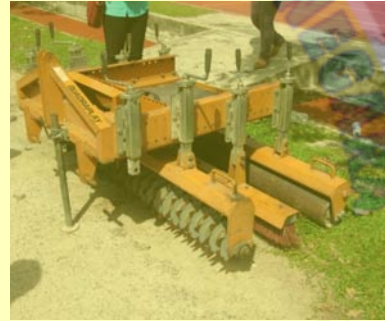
Gambar 3.22: Peralatan pelbagai fungsi ( brusher, slicer, roller ) digunakan untuk menyapu, mengudarakan tanah dan memadatkan tanah.
