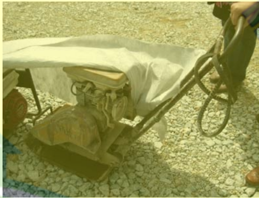
Gambar 3.19: Mesin pemadat yang digunakan untuk merata dan memampatkan tanah untuk kawasan yang berskala kecil.
