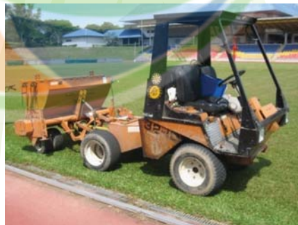
Gambar 3.23: Peralatan spreader , digunakan untuk kerja-kerja pembajaan dan top dress .
